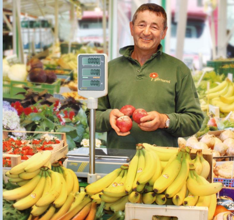
Preisrechnende Waagen kommen überall dort zum Einsatz, wo der Preis einer Ware durch Wägung ermittelt wird. Diese Waagen unterliegen der → **Eichpflicht** gemäß EU-Richtlinie 2009/23/EG. In der Regel handelt es sich hierbei um Waagen der Eichklasse **M III**.
